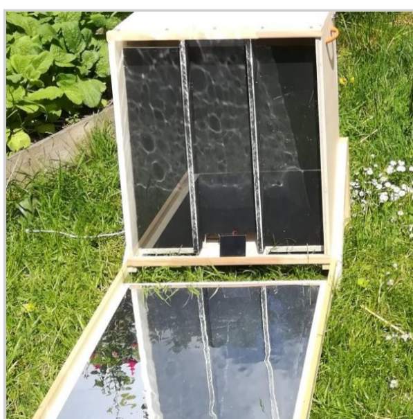
Séchoir solaire – Source Inti énergies solidaires
