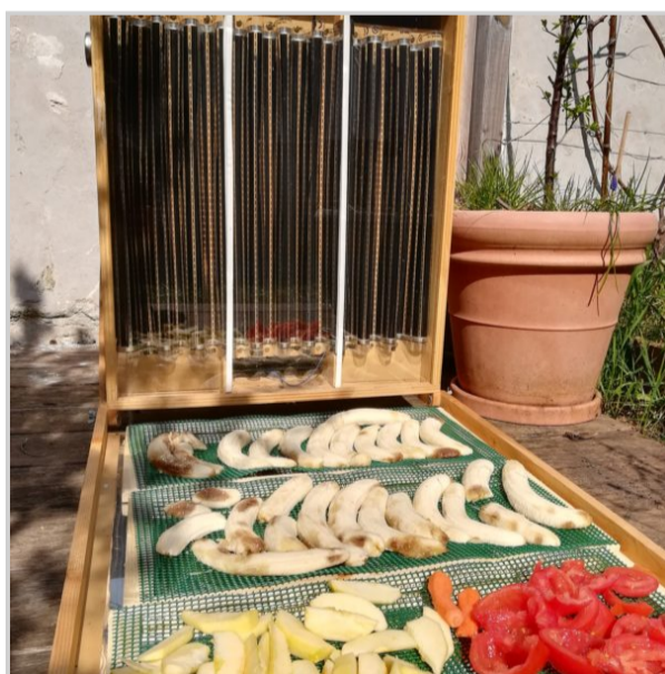
Séchoir solaire – Source Inti énergies solidaires
